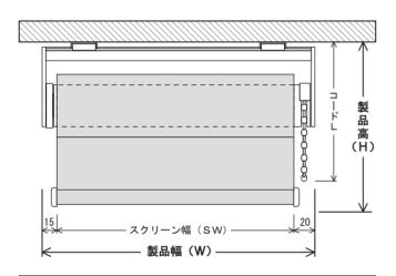
スクリーン幅(SW)=製品幅(W)-35mm
